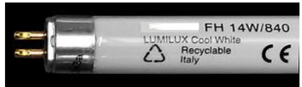
Tube fluorescent avec un marquage 840 indiquant un IRC de 80 à 89 et une température de couleur de 4 000 K (blanc neutre)
